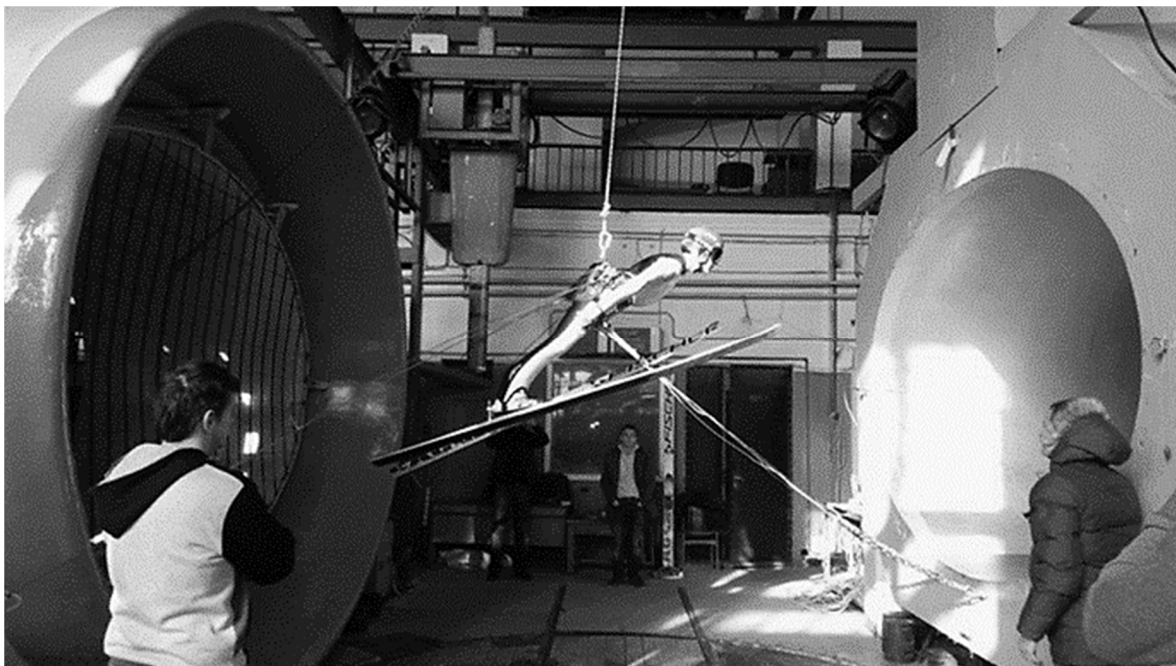
Рисунок 3. – Тренировка прыгунов с трамплина в аэродинамической трубе НИИ механики МГУ
