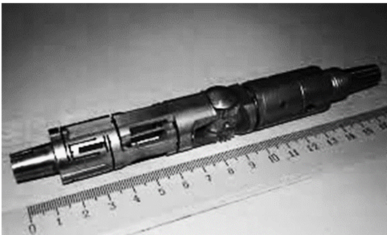
Рисунок 7. – Трубчатые шестикомпонентные тензовесы для измерения аэродинамических нагрузок
